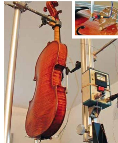
einem hochmodern eingerichteten Klanglabor. Mittdrin klemmt in einer Stahlhalterung eine Geige, auf die ein kleines Mikrofon ausgerichtet ist. Ein Computer zeichnet dessen Aufnahmen auf, allerlei Messapparaturen analysieren sie.
